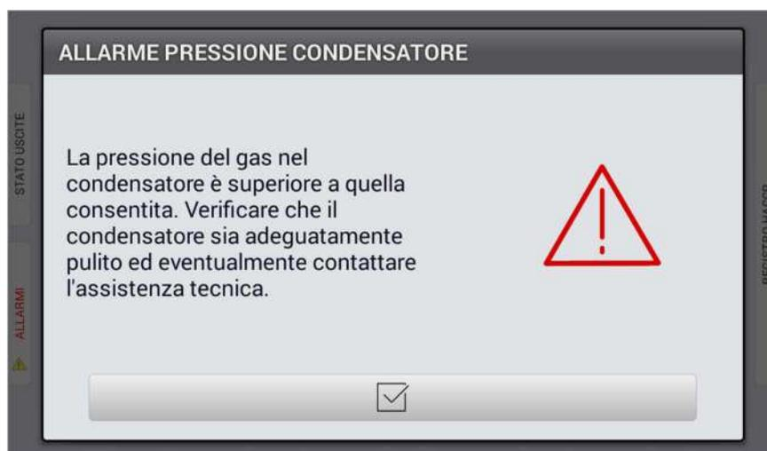
Come da immagine sopra, se la pressione del gas nel condensatore, dovesse superare il valore consentito, potrebbe comparire la comunicazione sopra.
