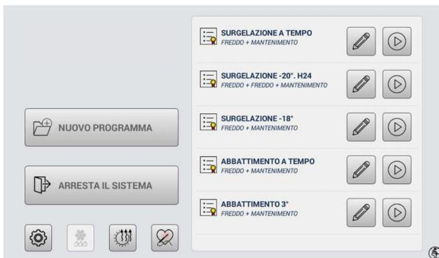
La videata sopra, dimostra cinque programmi salvati con la specifica del nome le funzioni utilizzate e le temperature di lavoro. Premendo il tasto a destra di ogni programma (la freccia) questo inizierà la lavorazione.
